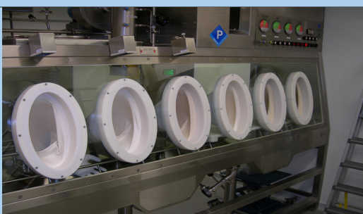
Wenn Substitution nicht möglich ist, gilt es die Exposition zu minimieren: Beispiel Glovebox als technische Massnahme der Expositionsminimierung
