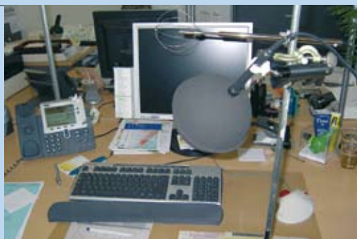
Abb. 3: Messung der thermischen Behaglichkeit an einem Arbeitsplatz.
