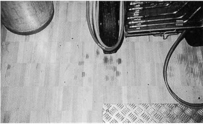
Wässriger Siegel war nicht inert: Bestandteile reagierten mit dem Gummireifen und führten zu durchgehenden Verfärbungen der Lackschicht
