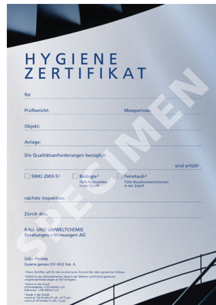
3 Beispiel für ein Hygienezertifikat, welches als Leistungsausweis einer einwandfrei arbeitenden RLT-Anlagen verliehen werden kann.
