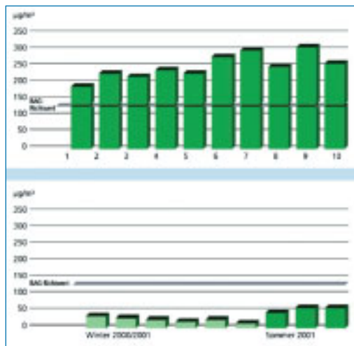
Formaldehydkonzentration im erneuerten Schulhaus (oben) und im Neubau (unten)
